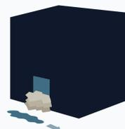
Sandsäcke dienen als mobiler Schutz vor Überflutungen. Werden Sandsäcken vor Hauseingängen, Lichtschächten oder tief liegenden Fenstern gestapelt, verhindern sie das Eindringen von Wasser ins Gebäude. Diese Maßnahme kann bei Starkregen nur für kleine Eingänge genutzt werden, da die Vorwarnzeit für den großräumigen Einsatz zu kurz ist.
