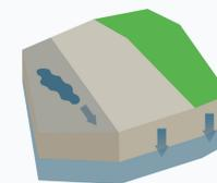
Durch Entsigelung wird die Versickerungsrate erhöht und der Direktabfluss verringert sich.
