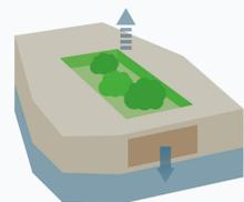
In Retentionstiefbeeten können Teile des im Straßenraum anfallenden Niederschlags temporär zurückgehalten und versickert werden [Benden, et al. 2017]. Sie erhalten eine gezielte Beetbepflanzung [Pyka 2020] und werden üblicherweise in unmittelbarer Nähe zum Straßenkörper angelegt [Sieker & Neidhardt 2018].
